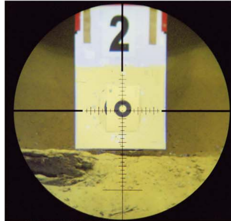
Das Testzielfernrohr in Gestalt des IOR 4-28x56. Okulareinheit im Detail. Absehen bei 28facher Vergrößerung auf 100 Metern.
